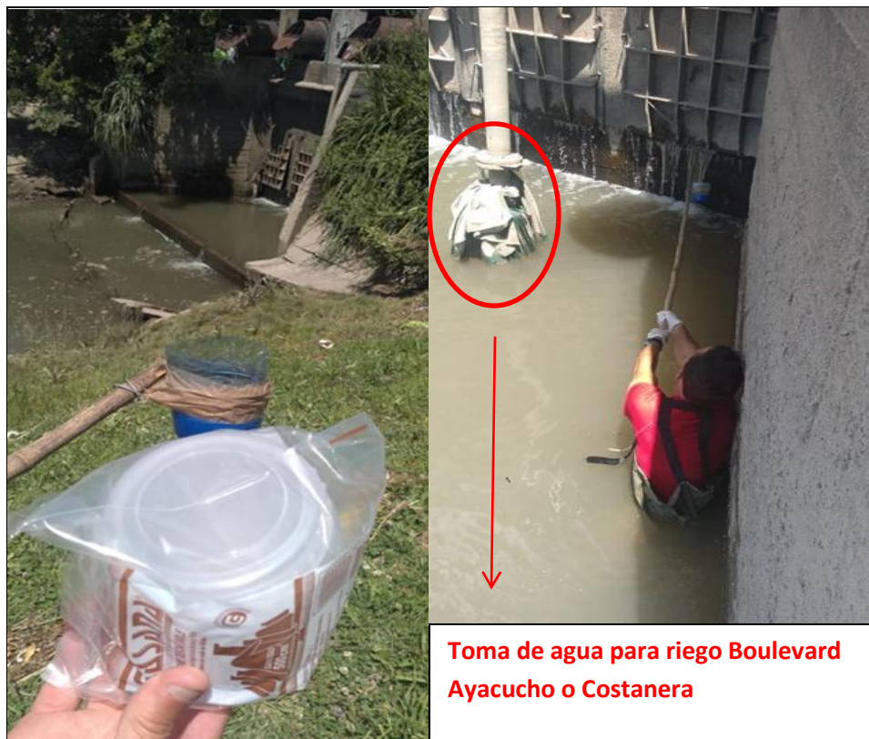
Figura 16 (izq). Portarecipiente y recipiente estéril. Figura 17 (der). Toma de Muestra 3, descarga pluvial (14/01/2019)
