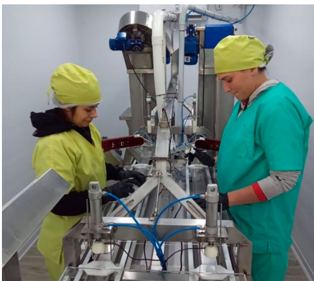
Imagen 8. Multiplicación de biocontroladores mediante sistemas de automatización con tecnología "pick and place". Sala de siembra de Gonizus legneri – CEMUBIO - INTA Alto Valle, 2025. Foto: S. Garrido.
